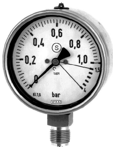
Manómetro con muelle tubular Tipo 232.36
