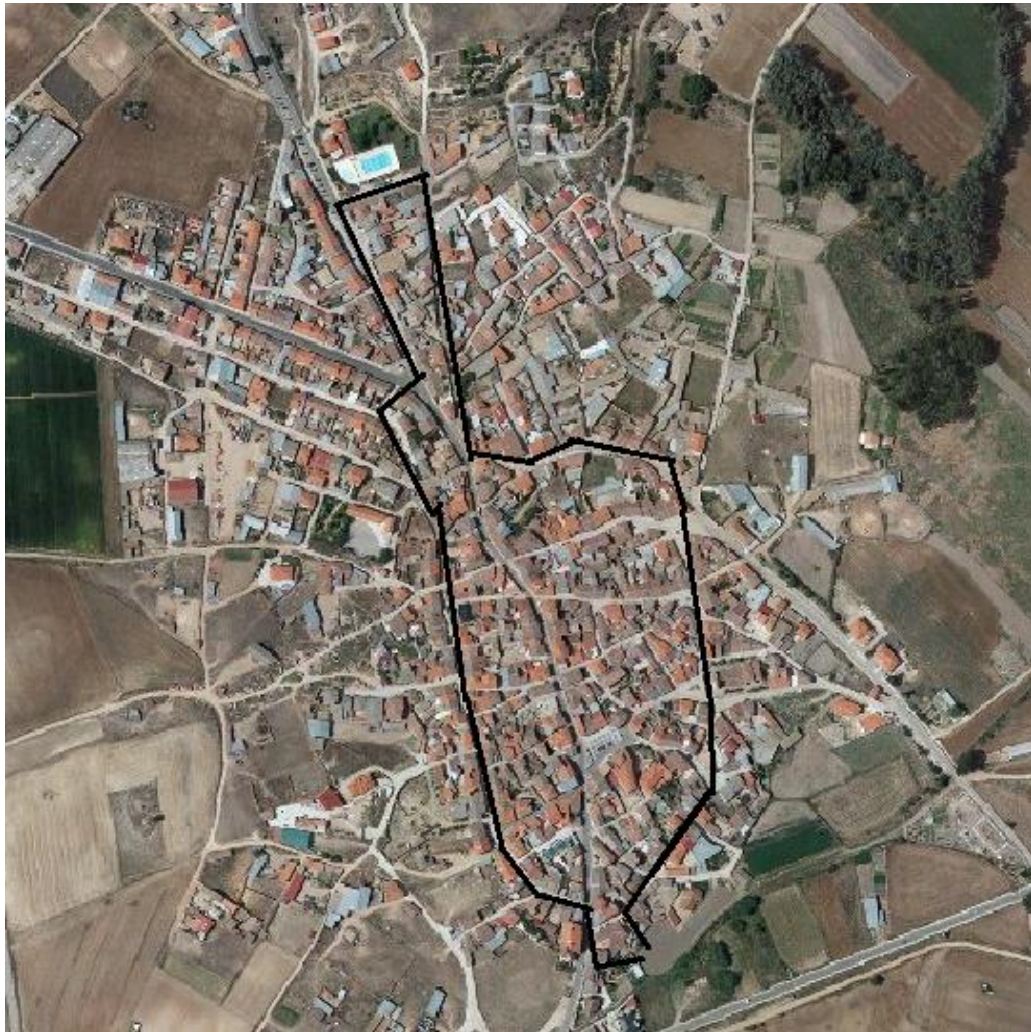
Figura6.3- Trazado de tuberías del district heating
