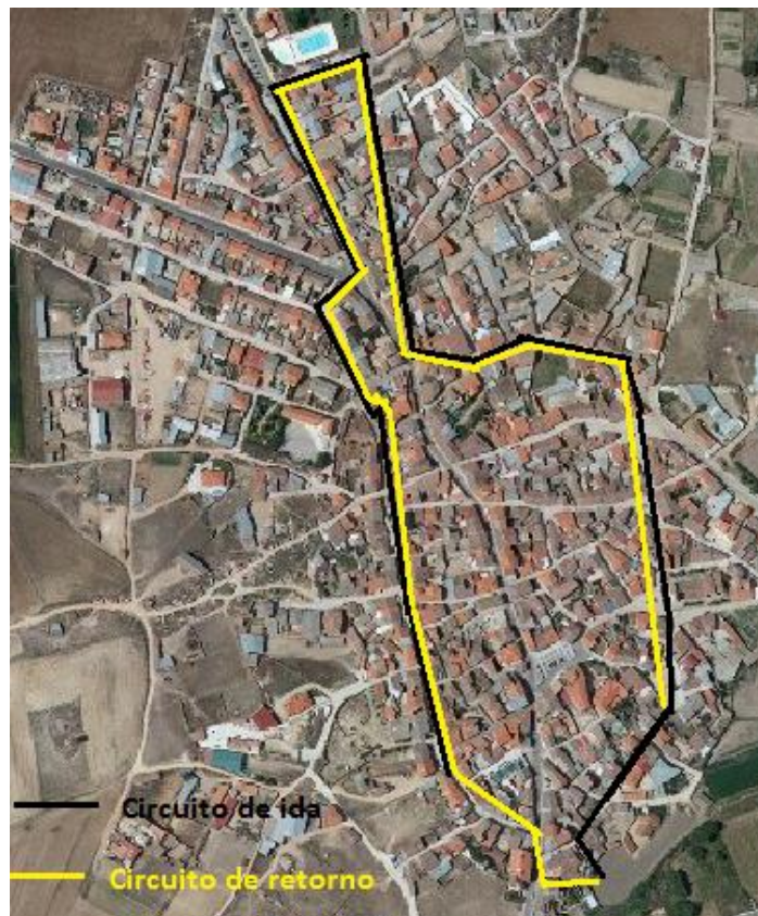
Figura6.4-Trazado de los circuitos de calefacción de ida y retorno
