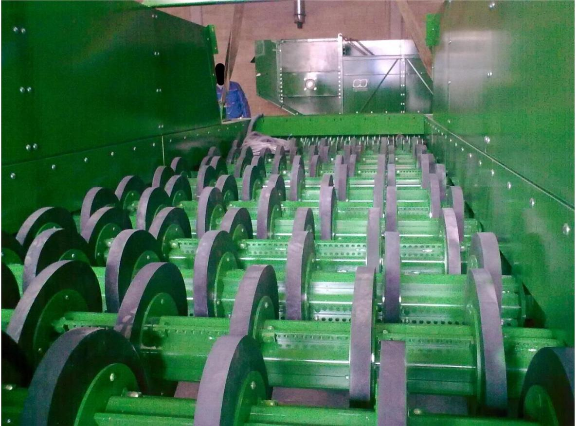
Figura 6.13.– Selector de discos de la empresa Recovery S.A.
