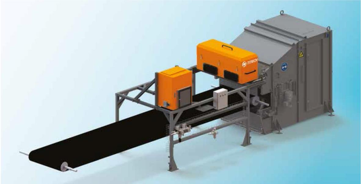
Figura 6.34.– Separador óptico de envases de la marca Titech en un modelo 3D
