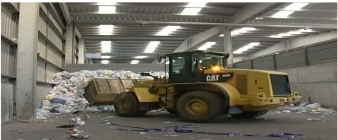
Figura 6.5.– Pala cargadora recogiendo los residuos depositados en el CTR de Palencia
