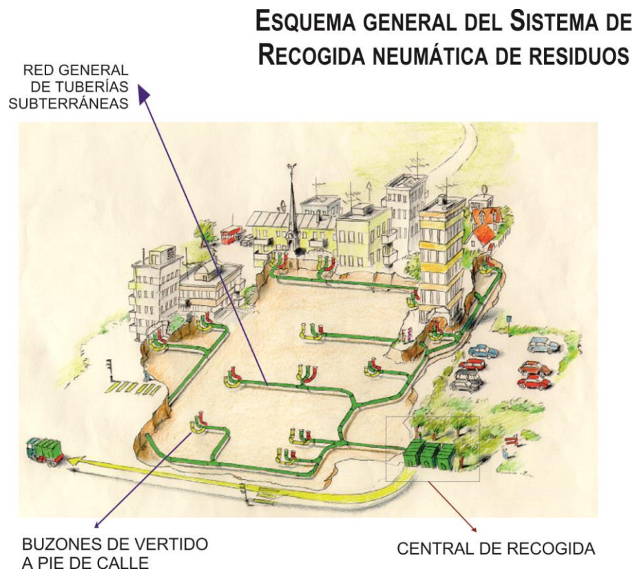
Figura 2.2.- Esquema general del sistema de recogida neumática de residuos.
