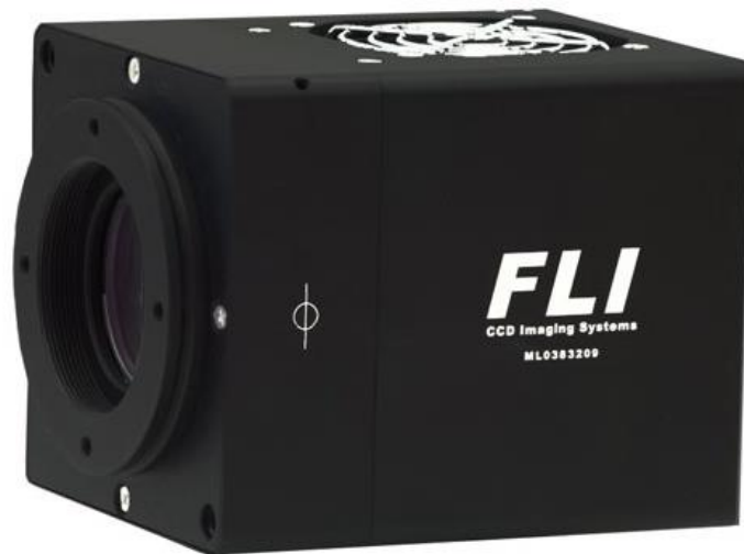
Ilustración 7-1. FLI ML3041-1-BB-4-MicroLine Fairchild CCD3041B1-BB-4 CCD Camera.
