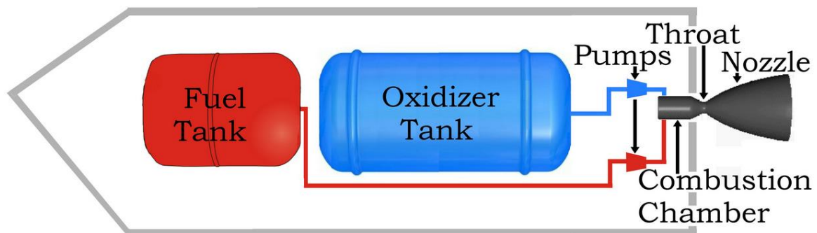
Ilustración 5-3. Esquema de un cohete de propulsante líquido.
