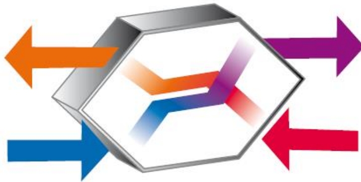
Figura 11.32 – Esquema de funcionamiento de un intercambiador de flujo paralelo a contracorriente.
