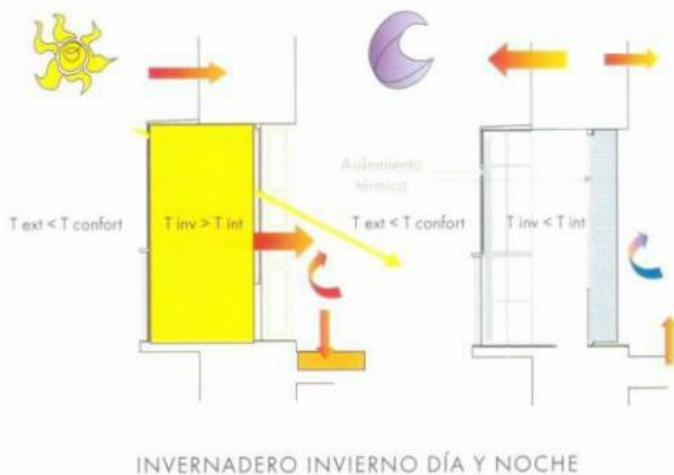
Figura 11.12 – Circulación del aire entre la galería y la vivienda en invierno.
