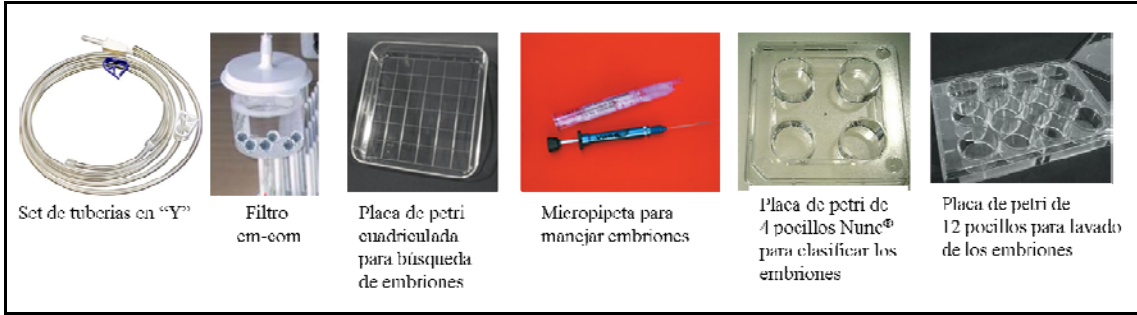
Foto 30: Set de tuberías, filtro para embriones, placas de petri para búsqueda, clasificación y lavado de los embriones, micropipeta para manejar los embriones.
