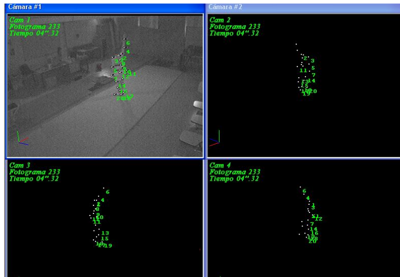
Figura 7: Detección y seguimiento de los marcadores utilizados con el sistema de análisis 3D CLIMA®-STT desde las cuatro cámaras.
