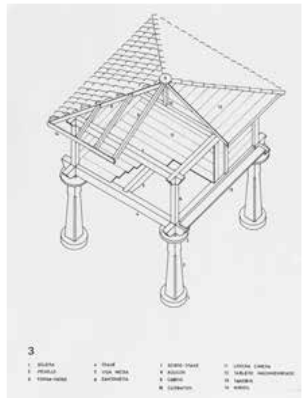
FIG. 09.17 Hórreo con bastidor y cubierta a cuatro aguas. Dibujo de E. Luelmo.
