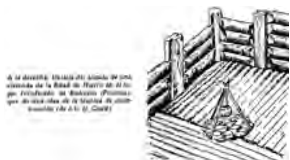
FIG. 12.17 Técnica constructiva con rollizos y puntales. En E. Frankowsky, Hórreos y palafitos... , p. 377.
