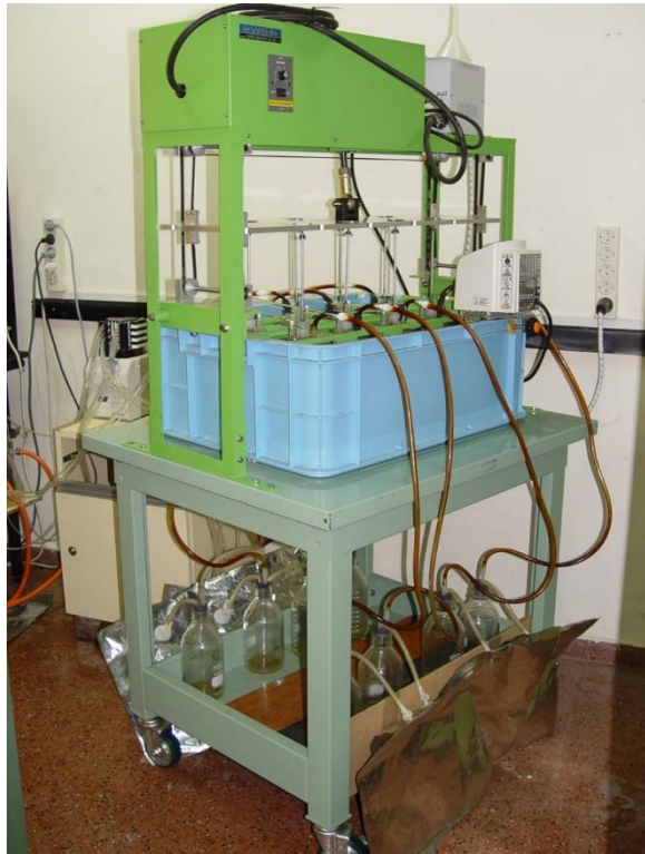
Figura III.2 Sistema de fermentadores de flujo semicontinuo Rusitec (Czerkawski y Breckenridge, 1977))
