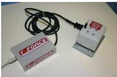
**Ilustración 1.** Transductor lineal de posición y velocidad T-Force
