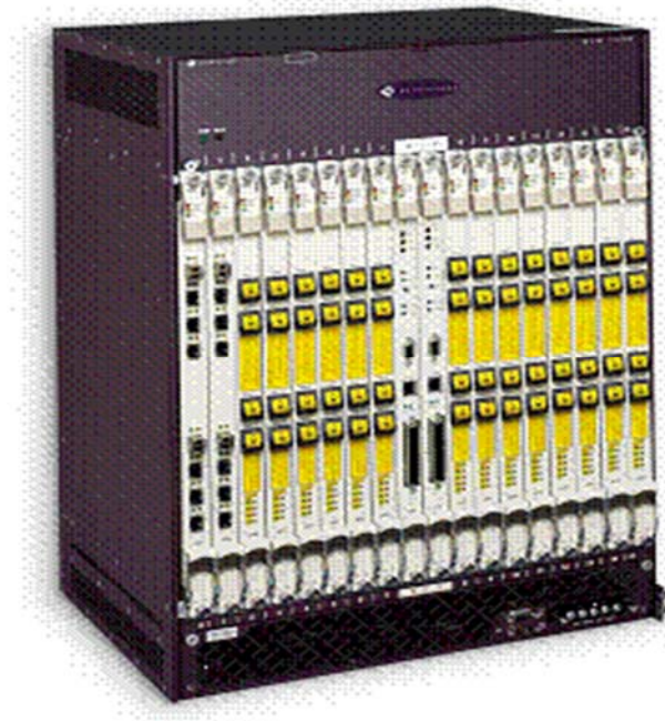
Figura 3: Nodo óptico OLT. Fuente: [RJMillán]
