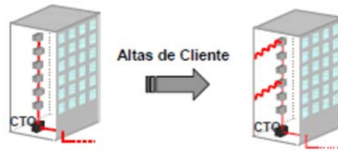
Figura 31: Despliegue con cable multifibra preinstalado y cajas de derivación. Fuente: [CMT6]
