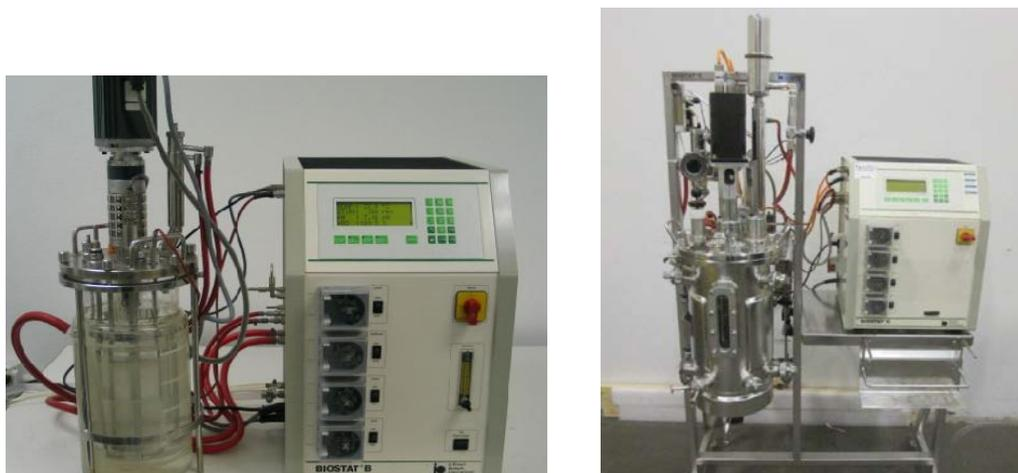
**Fig. 39: Biorreactores:** Braun Biostat® B 5L (izda.) y Braun Biostat® C 20 L (dcha.).
