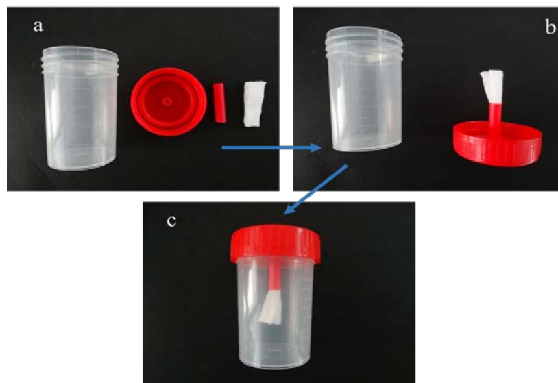
Figura 15: a) Componentes de la cámara de fumigación; b) montaje de la cámara; c) cámara fumigación.
