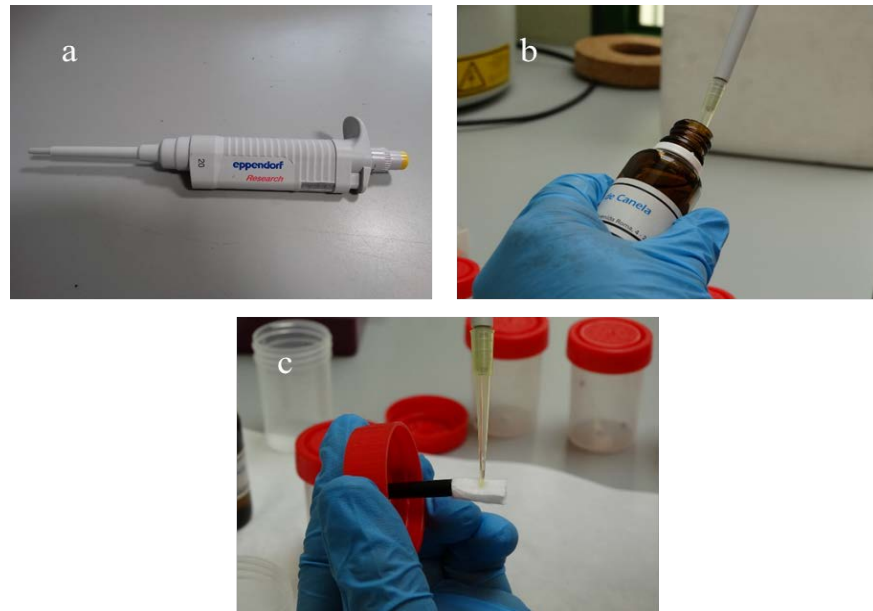
Figura 14: Aplicación de los aceites: a) micropipeta; b) pipeteando el aceite; c) aplicación en el trozo de algodón.
