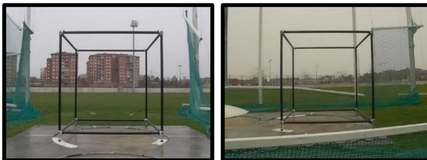
Figura 3.3. Sistema de referencia 2x2x2 m utilizado en la tercera concentración.
