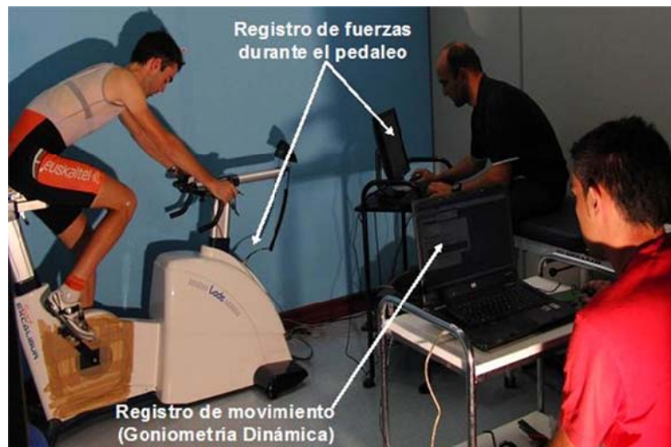
Figura-6.-Registro simultáneo de movimiento (Goniometría Dinámica) y fuerzas (LODE Excalibur) durante el proceso de posicionamiento del ciclista en su bicicleta.
