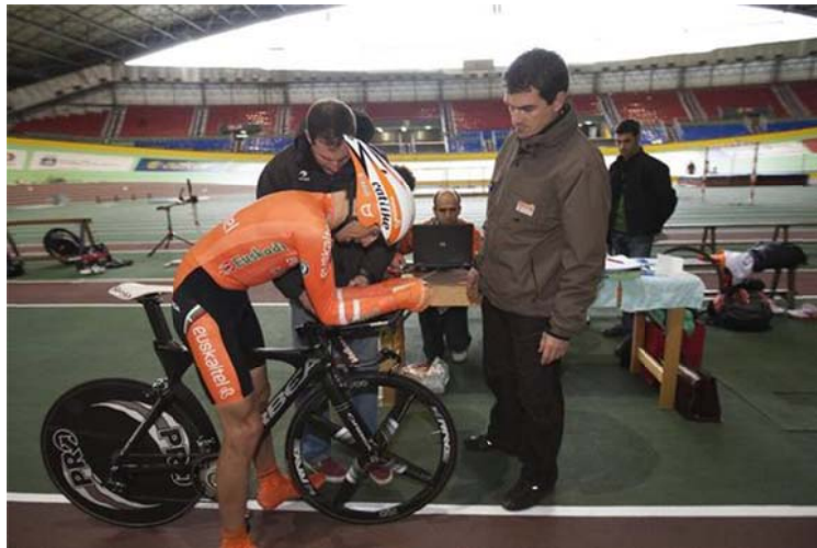
Figura-14.-Ajuste de las medidas de diferencia de alturas sillín-manillar ( h ) y largura ( Sc ) de la bicicleta de contrarreloj durante la realización de pruebas de aerodinámica en el Velódromo de Anoeta.
