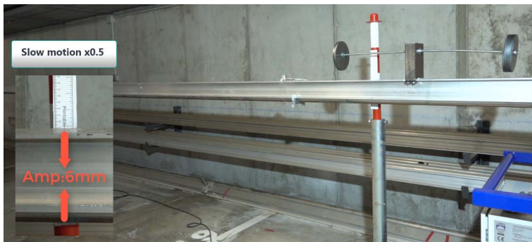
Figura 8.24: Ensayo de Modo 3. TMD activo
