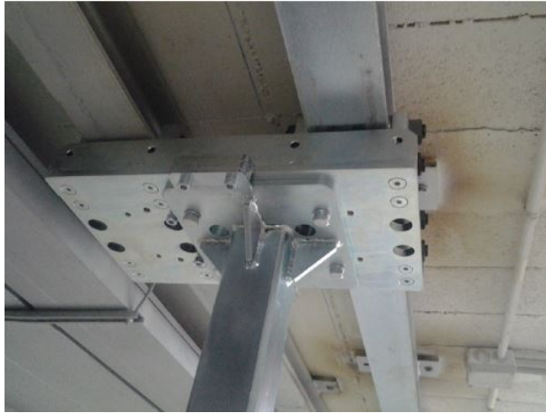
Figura 7.4: Carro móvil sobre el que se atornillan los mástiles
