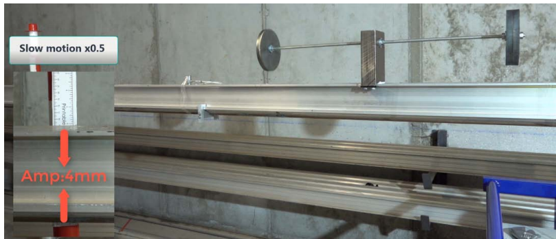
Figura 8.29: Ensayo de modo 5. TMD activo
