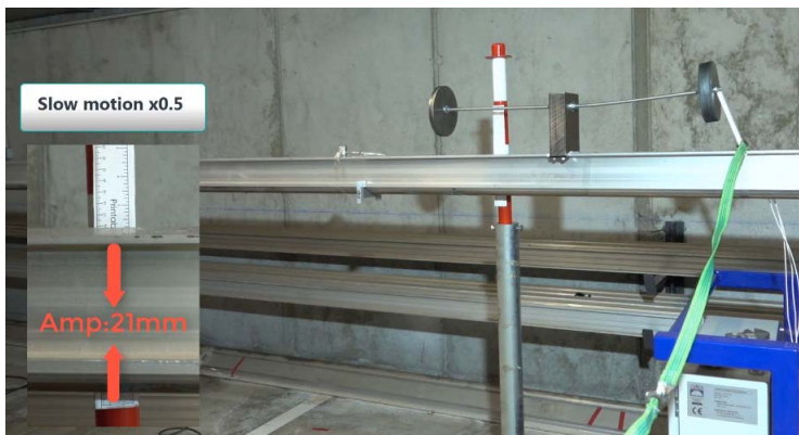
Figura 8.23: Ensayo de modo 3. TMD bloqueado
