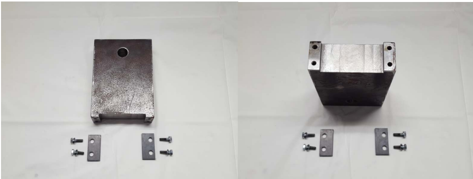
Figura 6.9: Despiece del bloque de acoplamiento
