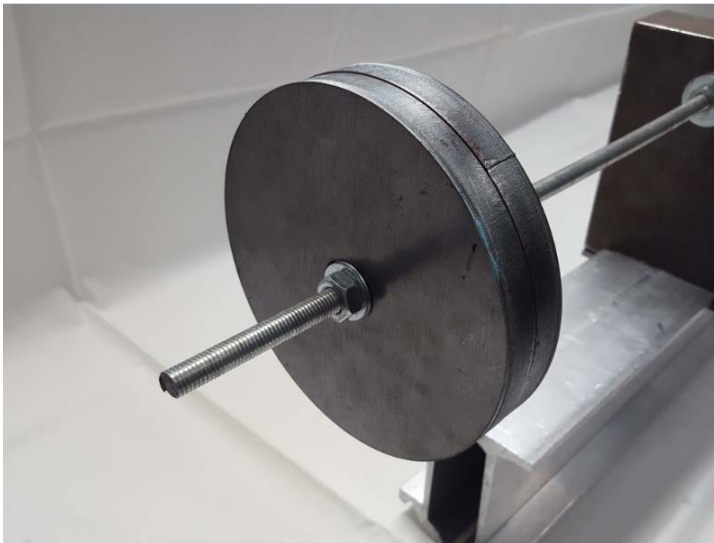
Figura 6.12: Masa del modo 8 (4,32 Hz)
