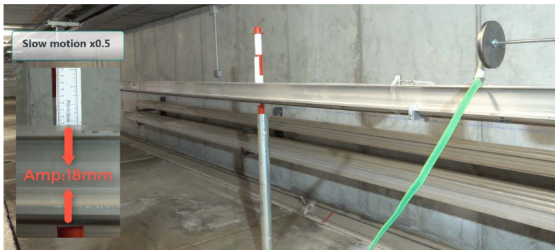
Figura 8.28: Ensayo de modo 5. TMD Bloqueado
