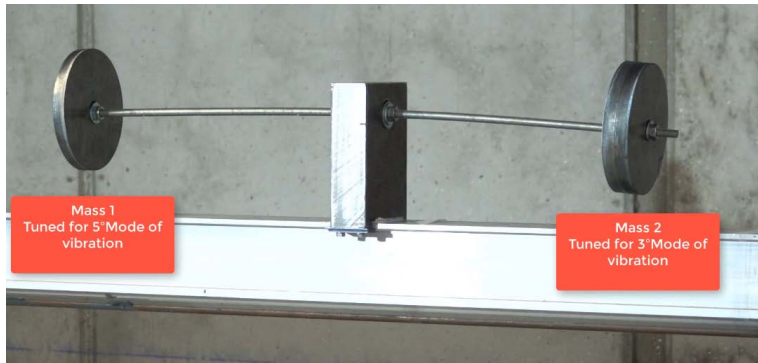
Figura 8.20: Prototipo y frecuencias de sintonización
