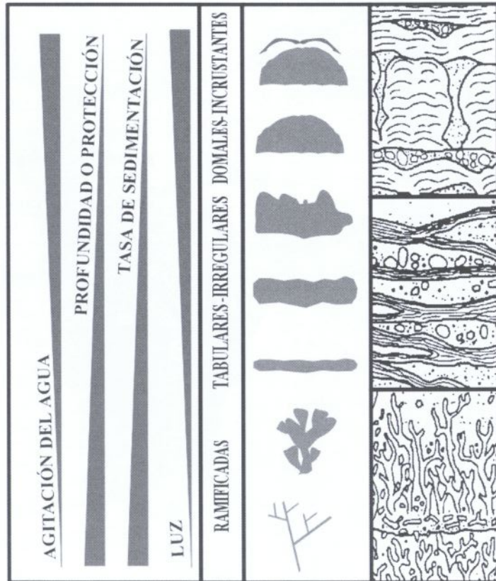
Figura 3. Esquema que muestra la relación entre distintos parámetros ambientales, la morfología de los esqueletos generados por los organismos constructores y el tipo de calizas resultante en cada caso (muy modificada a partir de varias figuras de JAMES y BOURQUE, 1992).
