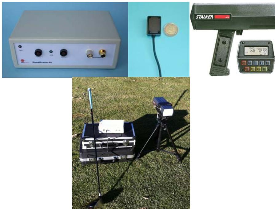
Figura 3.3: Material empleado en la toma de datos de aceleración del palo (Signal Frame- A) y velocidad de la bola (Radar Stalker modelo PRO®)
