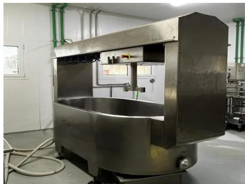
En esa máquina se mezcla la leche de las ovejas con los demás ingredientes y se procede a la elaboración de los quesos, que posteriormente serán incorporados a moldes de diferentes formas y tamaños según el tipo de queso.
