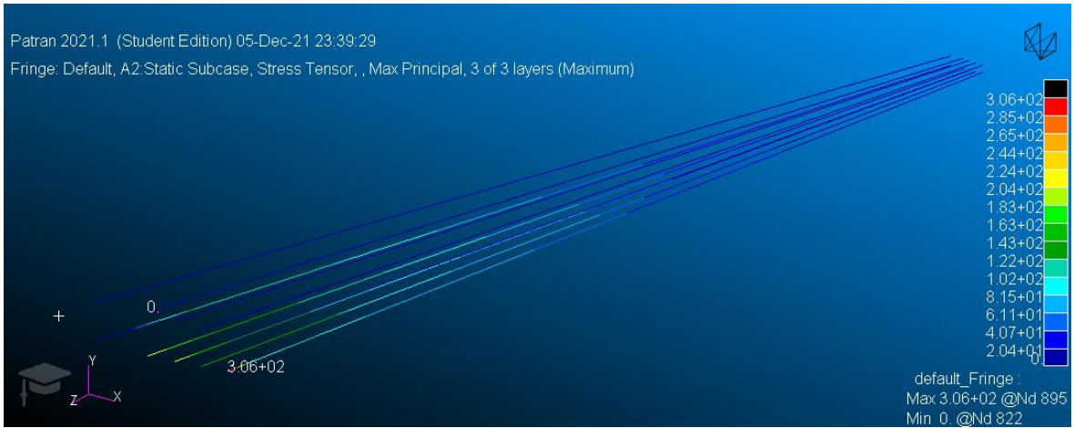
Figura 9.48. Larguerillos Máxima principal caso C (Fuente: propia)
