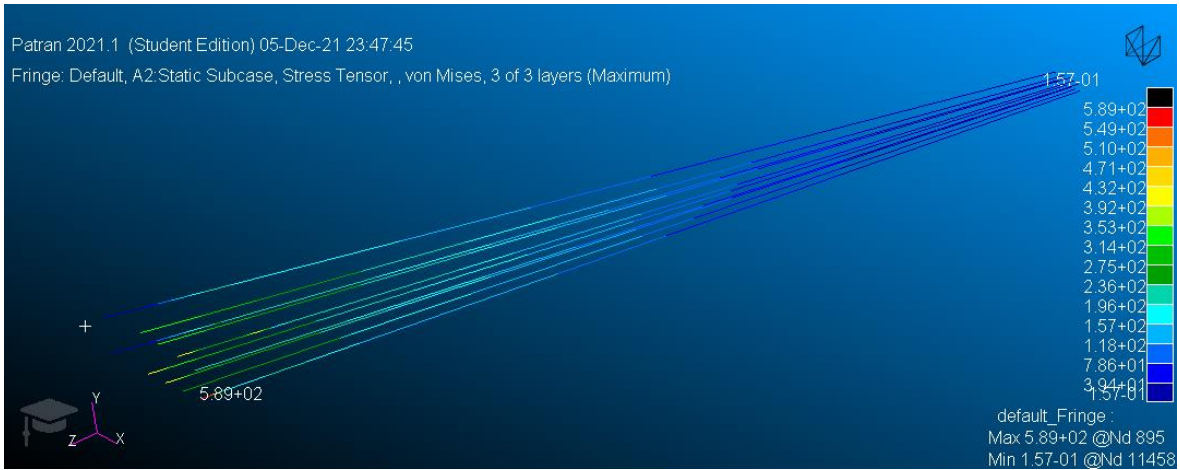
Figura 9.18. Larguerillos Von Mises caso B (Fuente: propia)
