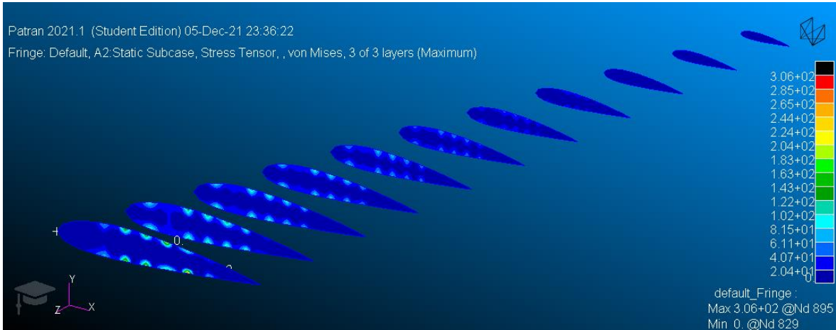
Figura 9.20. Costillas Von Mises caso C (Fuente: propia)
