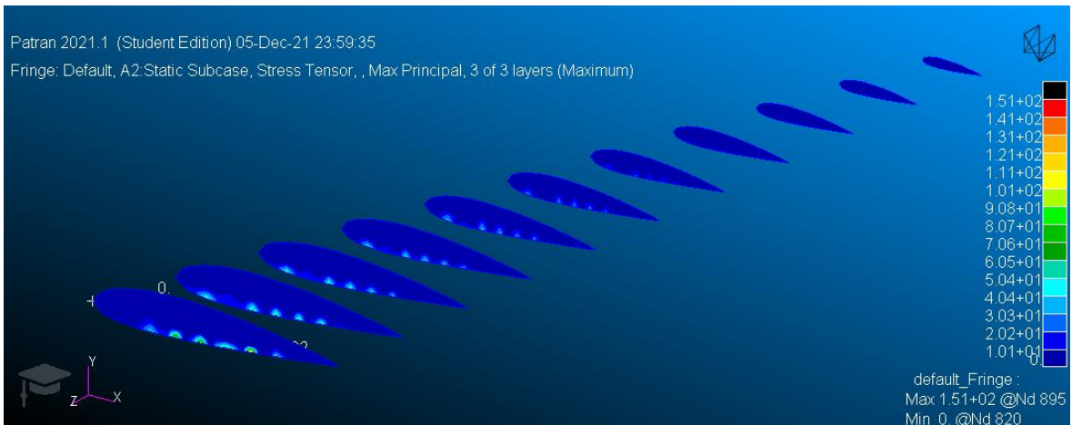
Figura 9.38. Costillas Máxima principal caso A (Fuente: propia)
