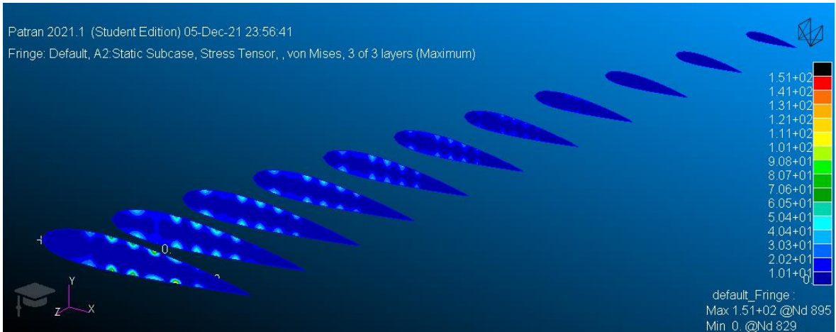
Figura 9.12. Costillas Von Mises caso A (Fuente: propia)
