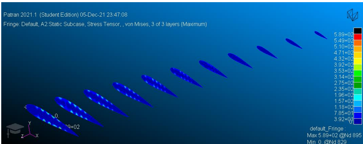
Figura 9.16. Costillas Von Mises caso B (Fuente: propia)
