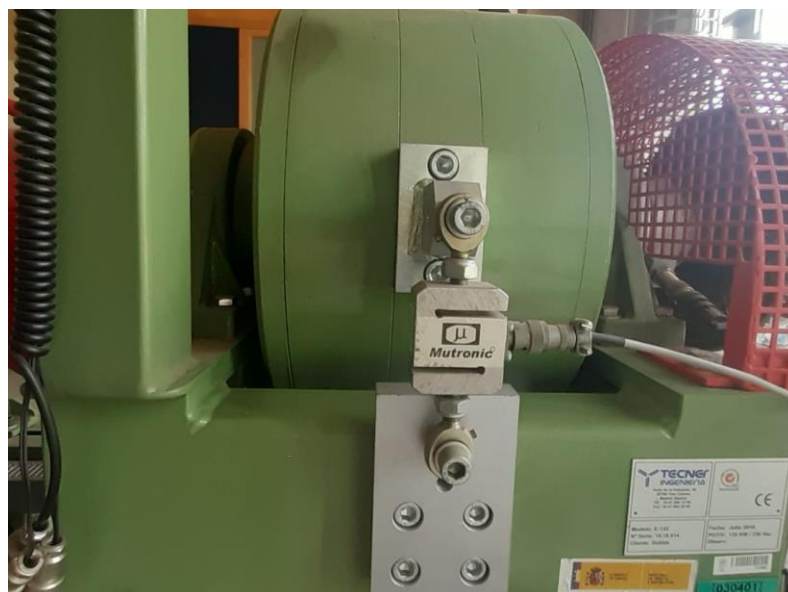
Figura 2.4. Fotografía de la célula de carga instalada en el banco de ensayos.
