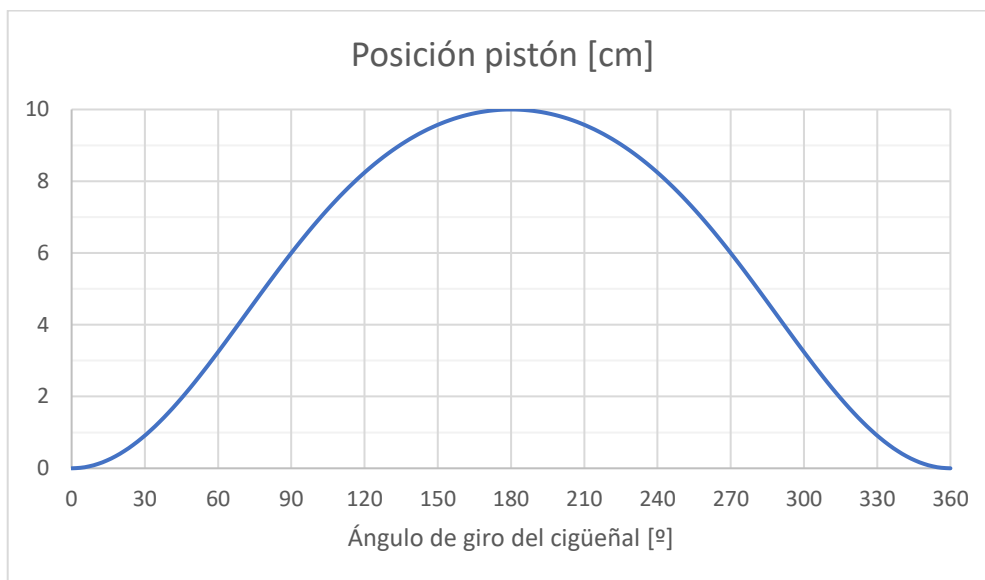
Figura 3.11. Curva con la posición del pistón en función del ángulo de giro del cigüeñal para s = 100 mm y L = 130 mm.
