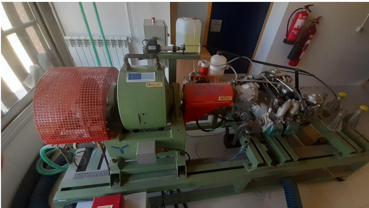
Figura 2.3. Fotografía del banco de ensayos Tecner E-135 y del motor Rotax 912.
