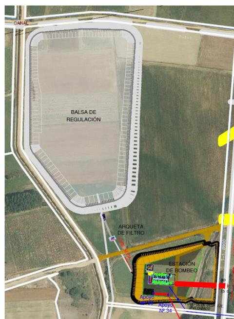
Figura 0.2: Balsa de regulación y estación de bombeo (Fuente: [1])
