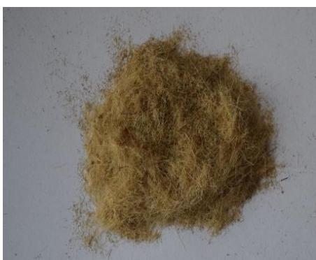
Figura 2 .– Muestra de lana de oveja sin el proceso de molienda.
