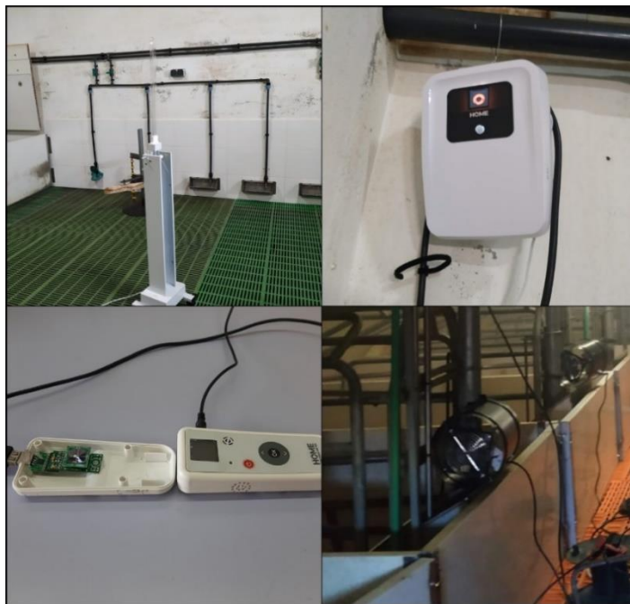
Imagen 12. Aparatos utilizados para generación y medición del ozono generado en la granja. De arriba izquierda hasta abajo derecha: lámpara de ozono, equipo home, lampara de ozono, sensor y cañón de ozono.
