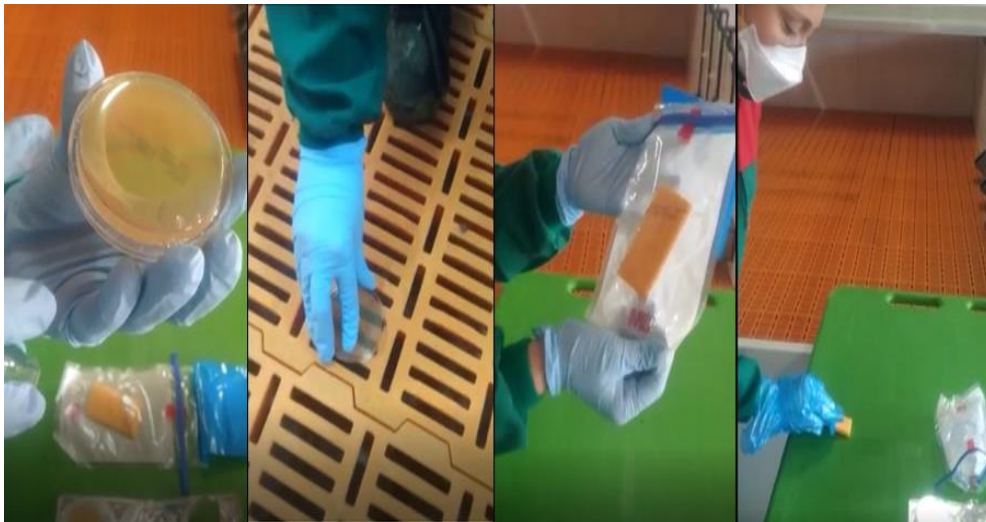
Imagen 4. De izquierda a derecha: placa RODAC para toma de muestras por contacto, placa tomando una muestra, esponja para la toma de muestras y esponja tomando una muestra
