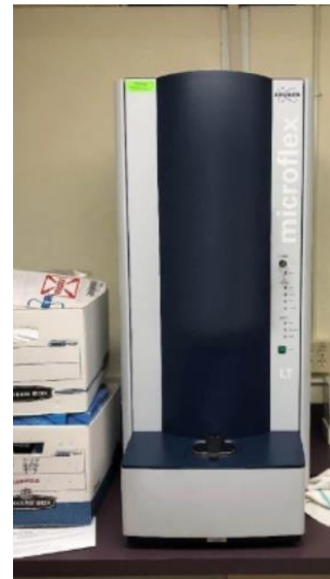
Imagen 5: (a) Fotografía de la placa del MALDI-TOF entrando en el espectrómetro de masas Microflex LT para ser analizada. (b) Espectrómetro de masas.
