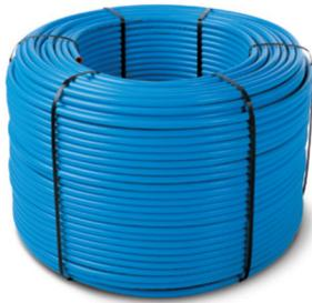
Tubo multicapa ALB azul para climatización radiante, 17 x 2; compuesto por una capa interior en polietileno PE-RT (DOWLEX 2388), una capa intermedia en aluminio de 0,2 mm de espesor, soldada a testa, y una capa exterior en polietileno (PE-RT). Presentación en rollos de 200 m ó de 500 m.
