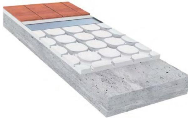
Fig. 5.3.1. Detalle suelo radiante seco.
