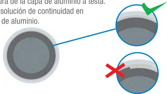
Soldadura de la capa de aluminio solapada; Produce una discontinuidad en el perímetro de la sección del tubo.
