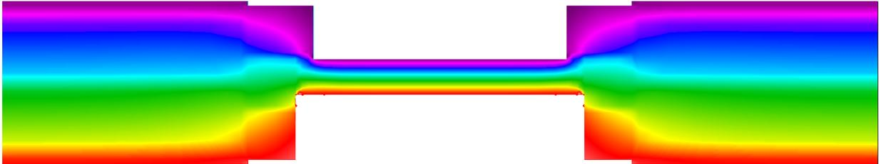
Fig. 6.3.6.3. Termografía del puente térmico en jambas.
