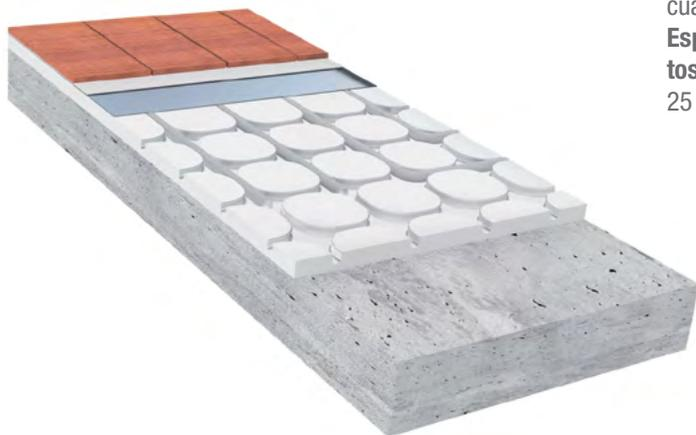
Suelo radiante de poco espesor, sin necesidad de mortero lo cual asegura una rápida instalación (sin tiempos de secado). **Especialmente diseñado para rehabilitaciones y proyectos con poca altura disponible.** Espesor total del sistema 25 mm más pavimento final.
