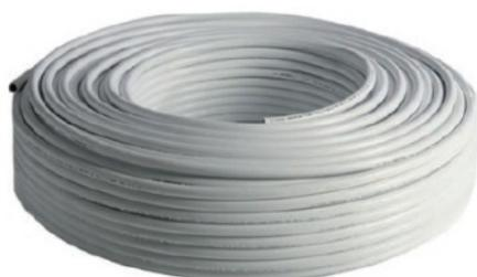
El tubo multicapa ALB diámetro 16 mm está compuesto por una capa interior de polietileno (PE-RT, Dowlex 2388), una capa interna de aluminio de 0,2 mm de espesor soldada a testa, y una capa externa de polietileno (PE-RT).
