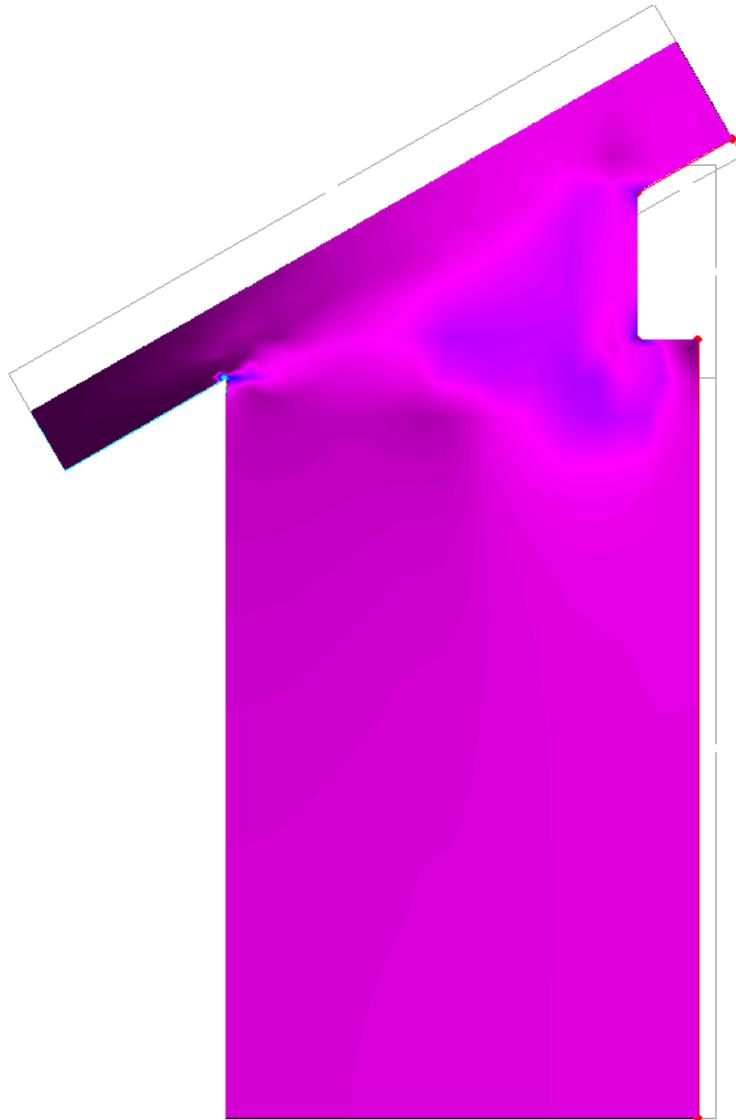
Fig. 9.2.2. Magnitud del flujo térmico encuentro cubierta
