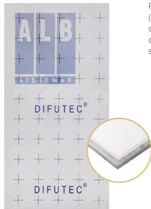
Panel aislante ALB-DIFUTEC®, fabricado en Poliéstireno expandido (EPS), autoextinguible (Euroclase E), de 10 mm de espesor. Dispone de una lámina superficial de aluminio de 0,25 mm, difusora del calor, provista de solapas autoadhesivas y cuadrícula de guía serigrafiada.
