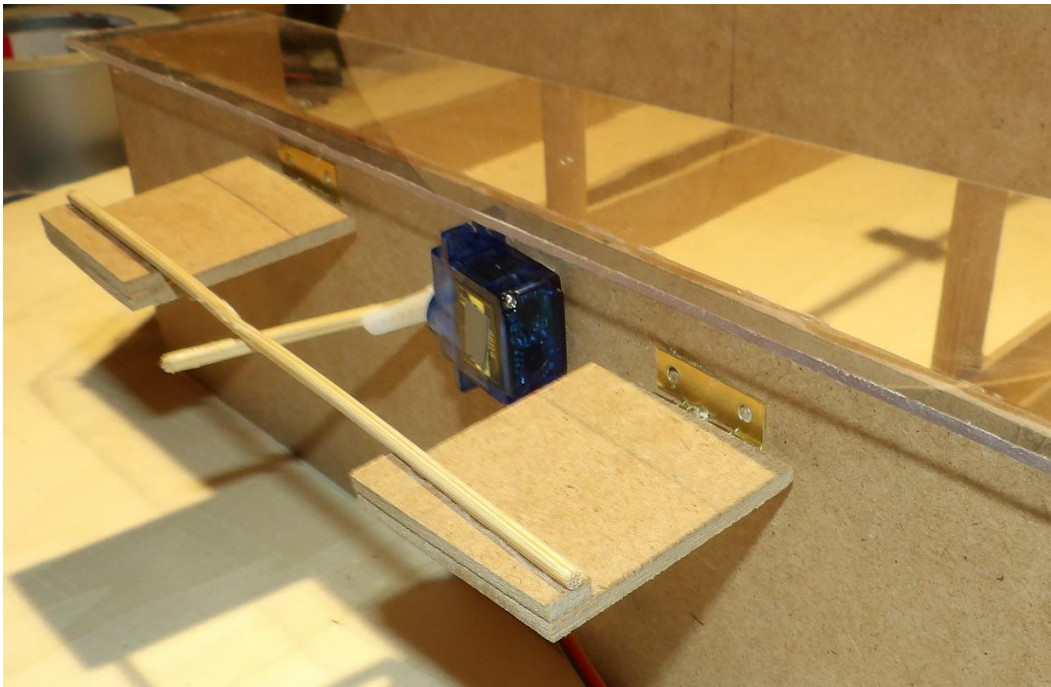
Figura 3.9: Servomotor abriendo las ventanas.
