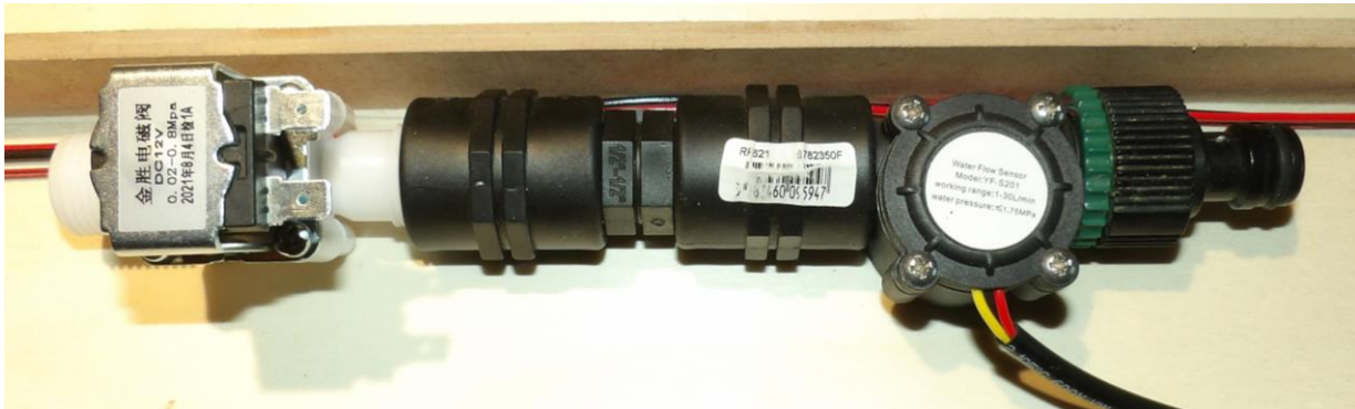
Figura 3.5: Electroválvula y caudalímetro.
