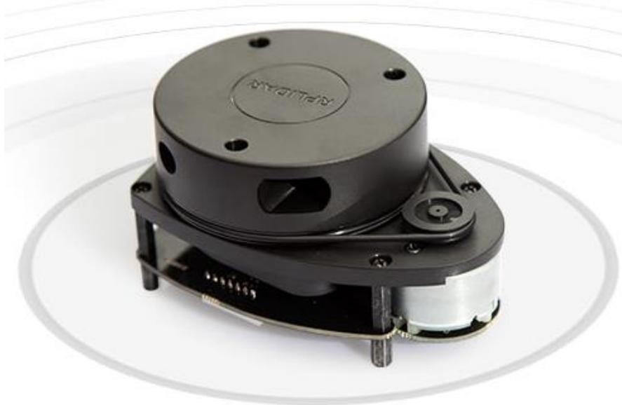
*Figura 4.1 RPLIDAR A1M8 (Fuente: [39]).*
