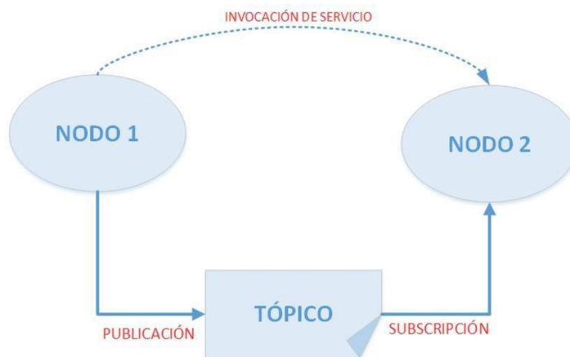
Figura 4.5 Funcionamiento protocolo de comunicación ROS (Fuente: propia).
