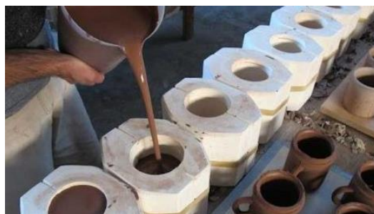
Ilustración 9: Relleno de moldes con barro.
