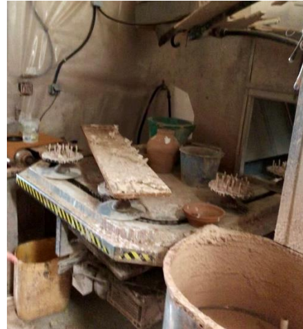
Ilustración 18: Máquina de esmaltado giratoria.
