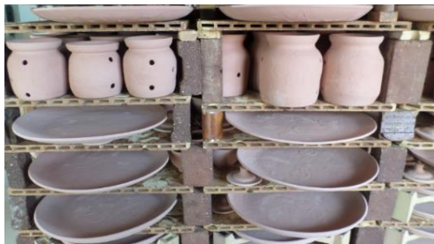
Ilustración 19, 20: Piezas en el horno, antes y después de la cocción a 1000 °C.
