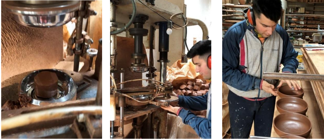
Ilustraciones 10, 11, 12: Proceso de elaboración de plato con prensa rotativa con chupón
