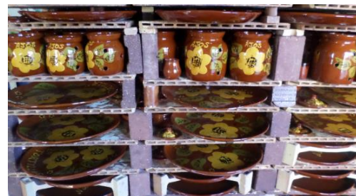
Ilustración 19, 20: Piezas en el horno, antes y después de la cocción a 1000 °C.
