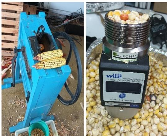
Figura 26. En la figura de la izquierda, se ve un desgranador manual y en la imagen de la derecha un medidor de humedad.
