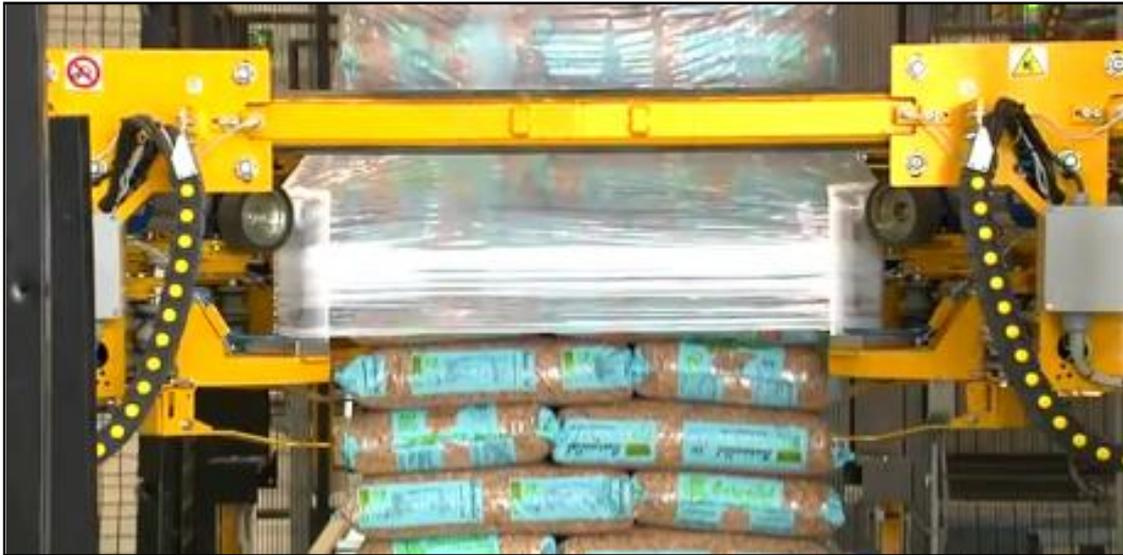
El embalaje se realiza mediante una funda elástica con fuerza de tensión por todos los lados con las siguientes características:
