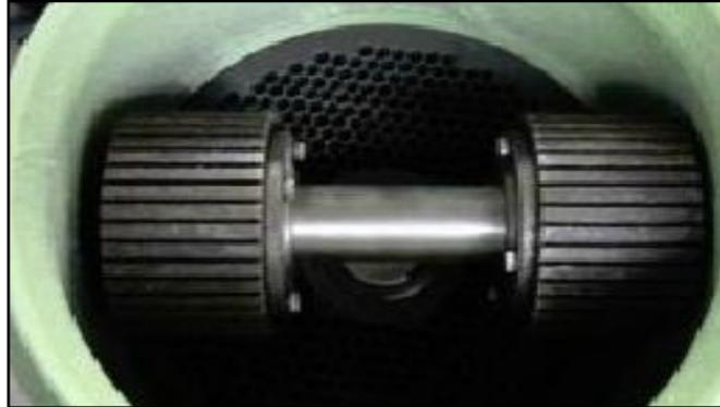
El proceso de pelletizado no necesita ningún tipo de aditivo, porque la madera libera una sustancia denominada lignina que actúa como aglutinante, y que junto a la presión de los rodillos, configuran los pellets. La lignina natural de la madera, con el calor y la presión de la pelletizadora, se derrite y es el momento donde se forma realmente el pellet. Posteriormente el pellet no presenta dureza hasta una vez enfriado.
