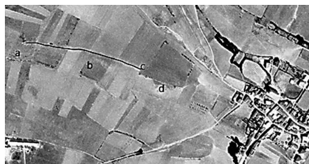
4. Vuelo Nacional de 1980-86 (zona entre Valdeviejas y Murias de Rechivaldo); “a”: torre de alta tensión; “b”: trayectoria del canal antes de conectar con el depósito inicial del sifón de Valdeviejas; “c”: depósito; “d”: comienzo del sifón.
