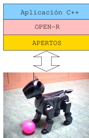
Figura 6. Arquitectura de software para el Aibo
