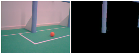
Fig. 1. Filtrado de color para la portería azul
