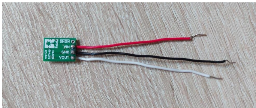
Figura 6.12 Entradas y salidas del regulador de tensión cableadas
