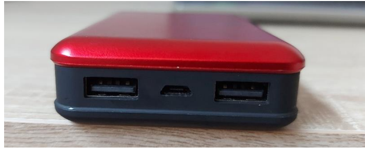
Figura 5.2 Entradas y salidas de la batería
