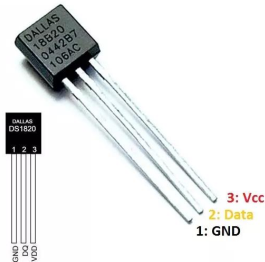
Figura 5.8 Sensor de temperatura DS18B20 (Fuente: [31])
