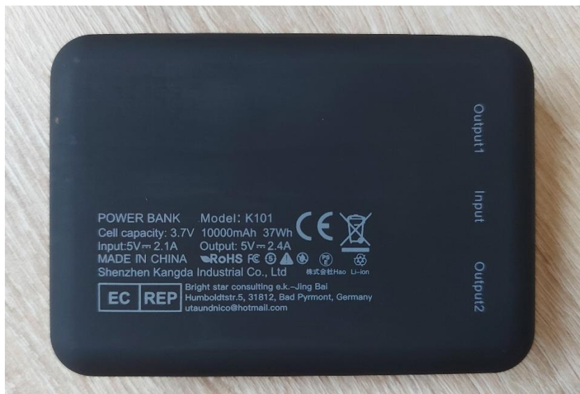
Figura 5.3 Parte trasera y especificaciones de la batería
