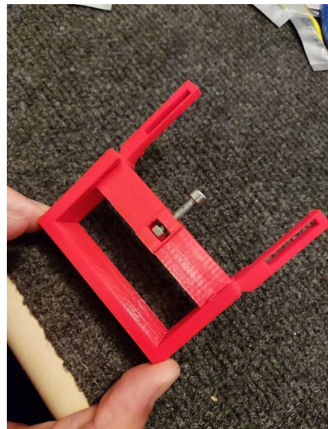
Ilustración 73 Soporte final carrera brazo
