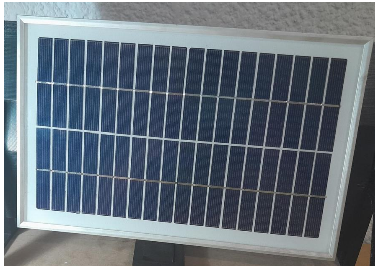
FIGURA 4.5 Fotografía panel solar 5 W [Fuente: elaboración propia]
