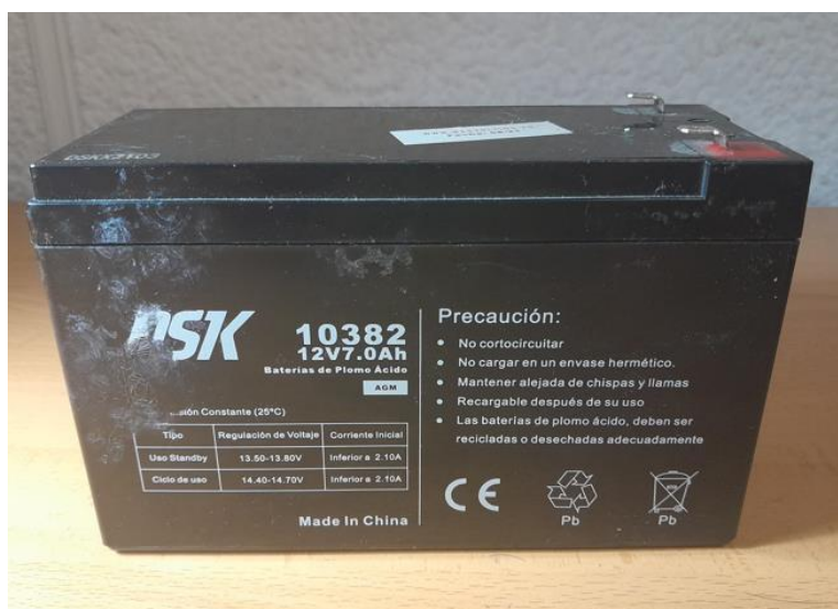
FIGURA 4.4 Fotografía batería DSK 12Vcc [Fuente: elaboración propia]
