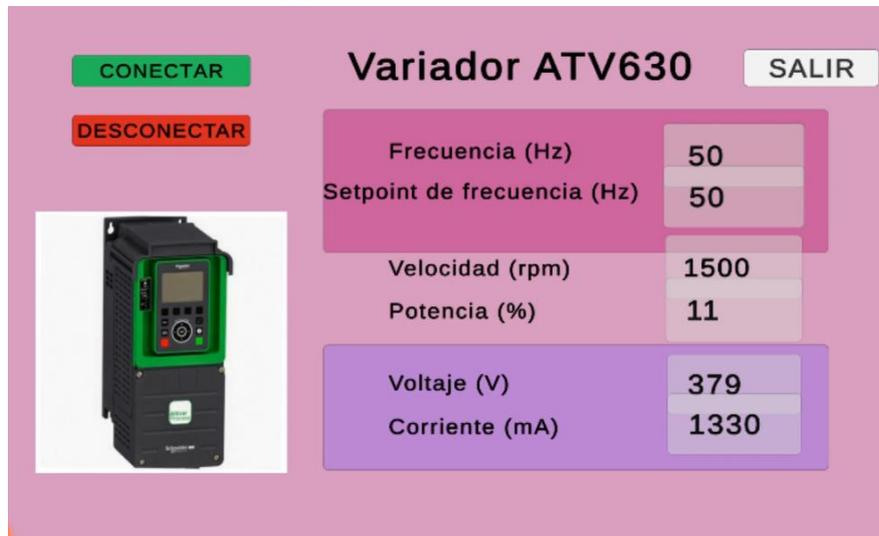
Figura 7. 2 Pantalla de supervisión del variador visto desde la Tablet
