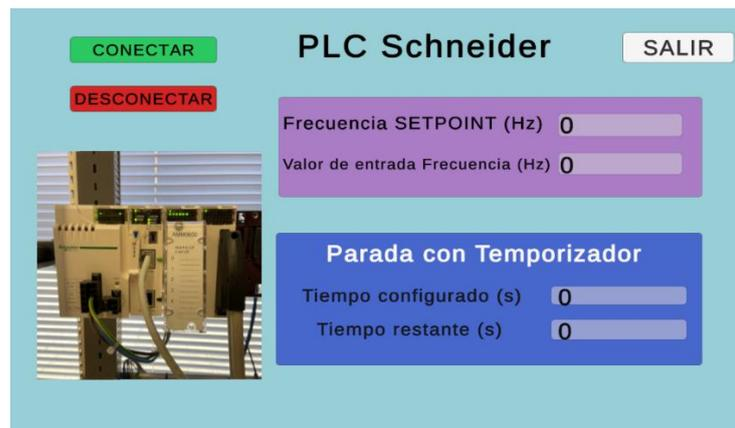
Figura 6. 17 Diseño de la pantalla final para el autómata
