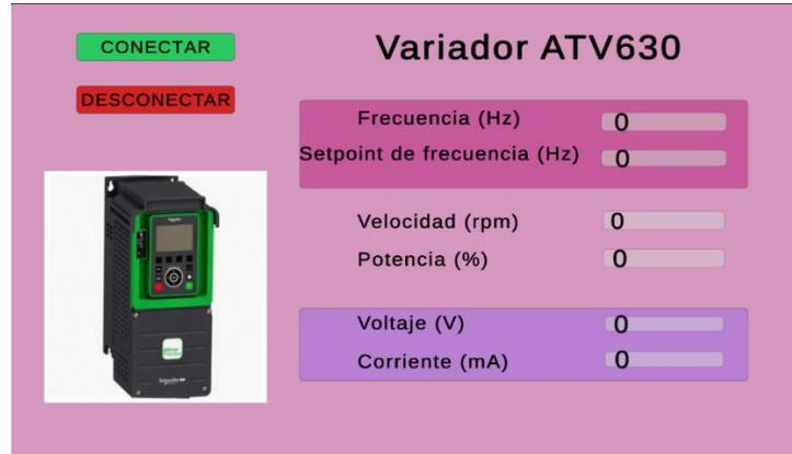
Figura 6. 16 Diseño de la pantalla final para el variador
