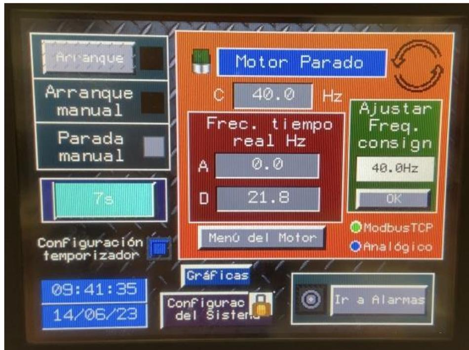
Figura 7. 6 HMI del PLC visto desde la pantalla del armario de control
