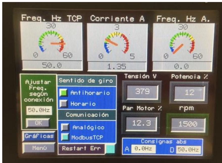
Figura 7. 3 HMI del variador visto desde la pantalla del armario de control
