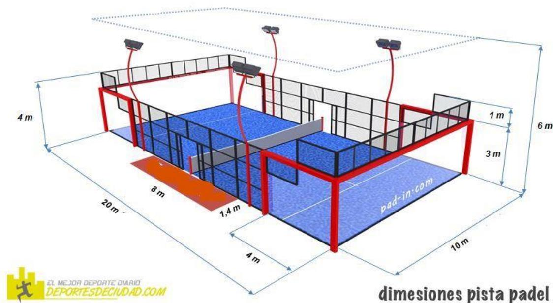
Figura 2 Dimensiones de una pista de pádel reglamentaria
