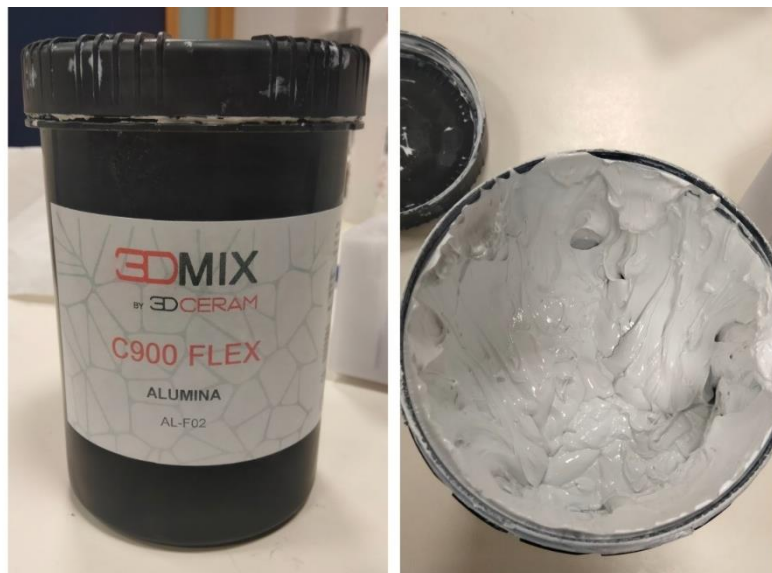
Figura 1.4: Pasta con base de alúmina usada en este proceso. Fuente: Elaboración propia.
