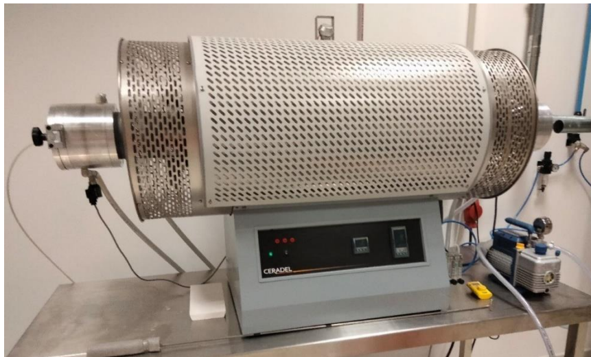
Figura 1.5: Horno de debinding de la UFI3D. Fuente: Elaboración propia.
