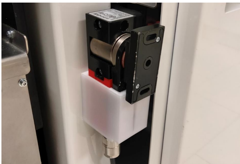
Figura 5.5: Primer prototipo de útil de sujeción por fricción. Fuente: Elaboración propia.
