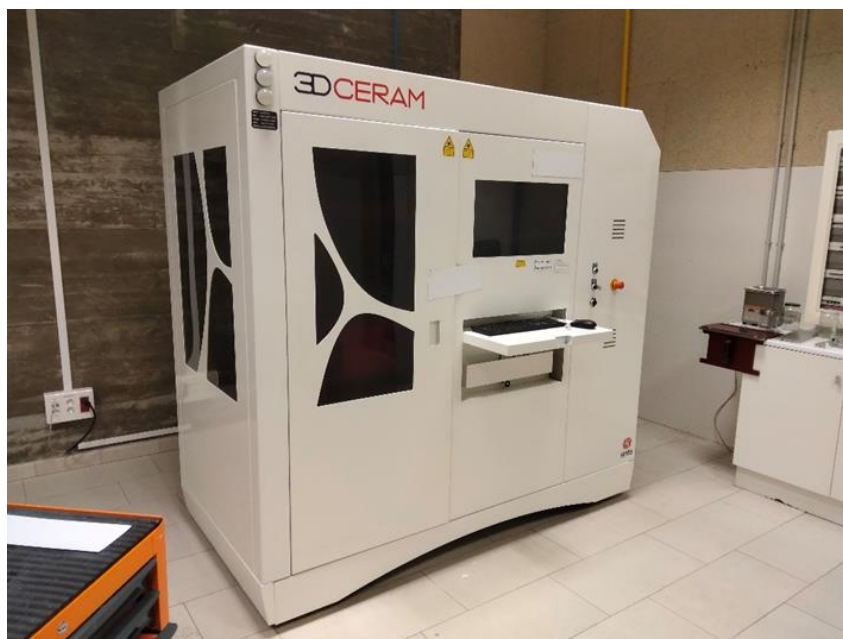
Figura 1.4: Impresora 3D SLA de cerámicas técnicas 3DCeram C900 Flex en la Unidad de Fabricación e Impresión 3D (UFI3D) de la ULE. Fuente: Elaboración propia.
