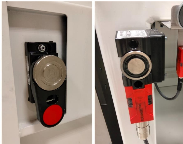
Figura 2.7: A la izquierda, pieza de la puerta. A la derecha, electroimán en la máquina. Fuente: Elaboración propia.
