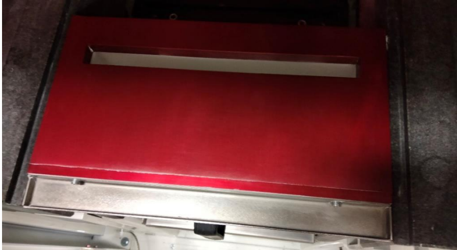
Figura 2.5: Placa de aluminio y ranura por donde sale la pasta.
