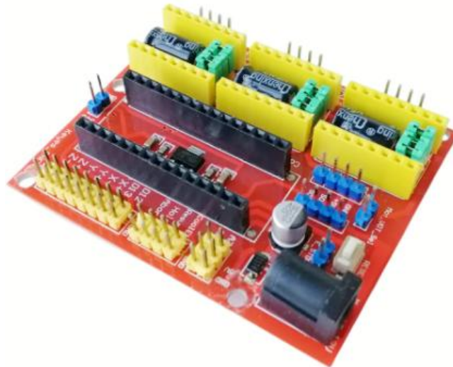
Figura 3.3. CNC V4 Expansion Board. (Fuente: [7])
