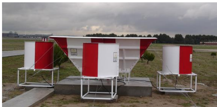
Figura 5.1: Perfilador de viento de AEMET en el aeropuerto Adolfo Suárez Madrid-Barajas. Fuente: [51]
