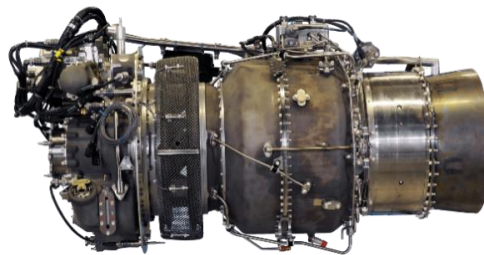
Figura 7.20. Motor turboeje Ardiden 3. (Fuente: Safran Group)
