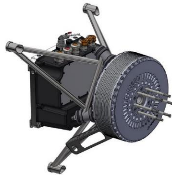
Figura 7.2. Simulación del motor Pipistrel E-811. (Fuente: Transportup)
