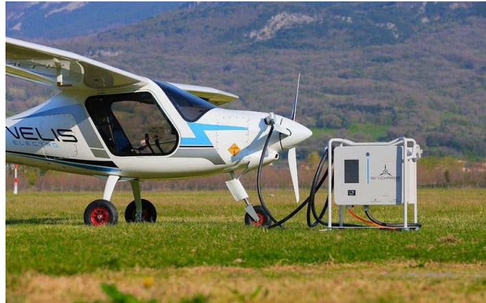
Figura 5.6. Sistema de carga del Velis Electro. (Fuente: Híbridosyelectricos)
