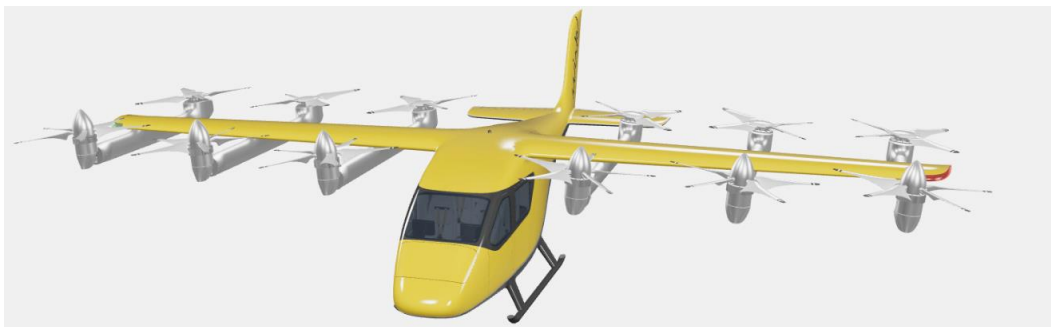
Figura 7.27. Disposición de los motores del Wisk Cora. (Fuente: Wisk Aero)
