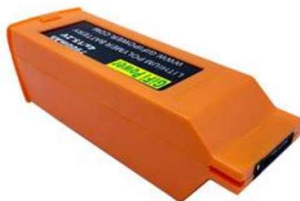
Figura 7.13. Batería de polímero de litio. (Fuente: Batteryupgrade)
