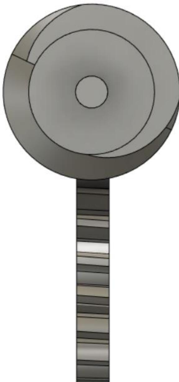
*Figura 4-16 – Perfil del sistema de tornillo sin fin - corona con rosca unificada en la corona.*
