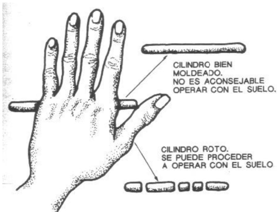
Fig. 2. Prueba de campo para determinar la humedad del suelo.
