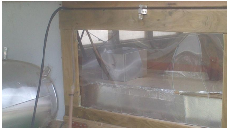
Figura 2.4.4.- Caja caliente en el interior del secadero.
