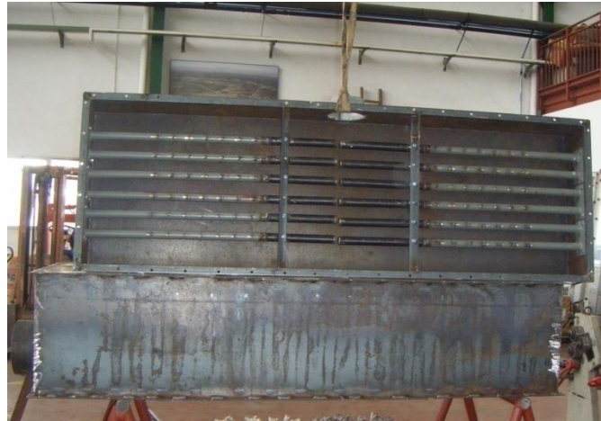
Figura 5.6.4. Tubos de hierro agujereados por donde sale el aire comprimido.
