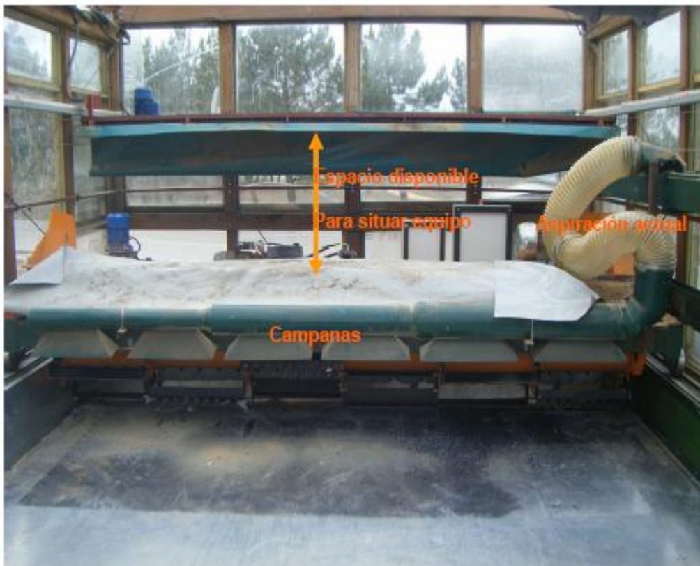
Figura 2.3.1.- Vista frontal de volteador con las campanas de aspiración y el sistema móvil.
