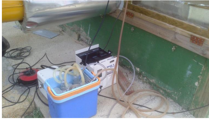
Figura 2.4.3.- Tren de muestreo, caja de control y unidad de bombeo.
