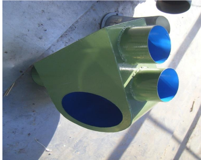
Figura 5.6.2.- Caja distribuidora terminada donde van conectados los tubos flexibles.
