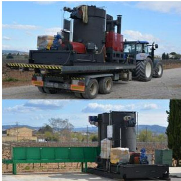
Figura 5.4. Pirolizador térmicamente autosostenible y móvil (PAM) en un viñedo
