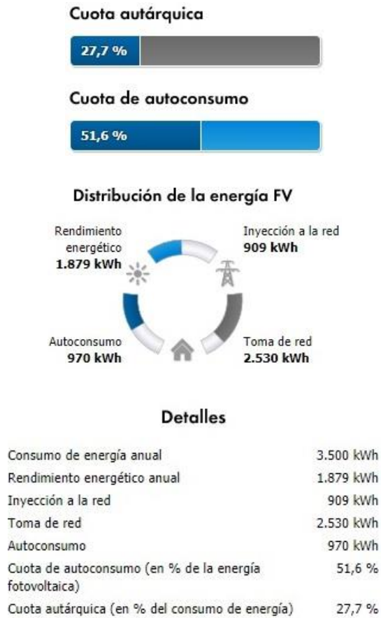
Figura 33. Sin optimización de autoconsumo. Perfil de consumo B (Zona Climática I). Fuente: Sunny Design Web.
