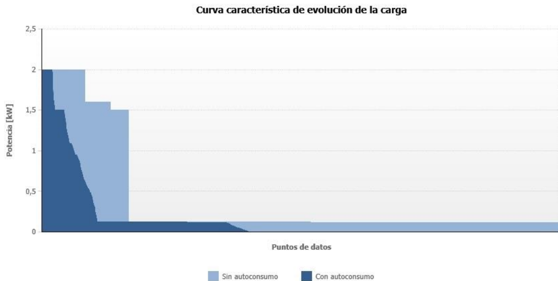
Figura 95. Curva característica de evolución de la carga sin y con autoconsumo. Perfil de consumo B (Zona Climática IV). Fuente: Sunny Design Web.
