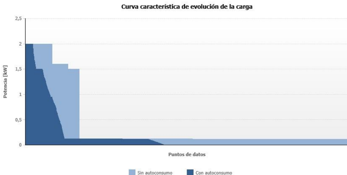
Figura 76. Curva característica de evolución de la carga. Perfil de consumo B (Zona Climática III). Fuente: Sunny Design Web.
