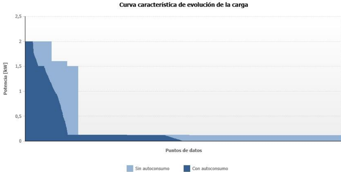
Figura 38. Curva característica de evolución de la carga. Perfil de consumo B (Zona Climática I). Fuente: Sunny Design Web.
