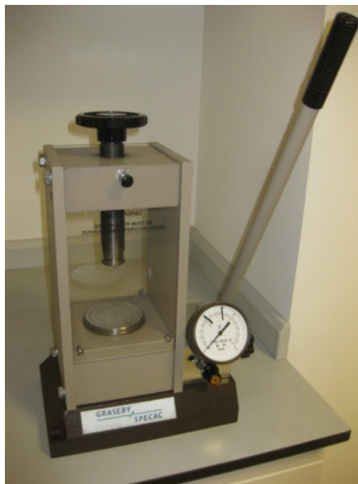
FIGURA 4.8. PRENSA HIDRÁULICA EMPLEADA PARA LA PREPARACIÓN DE LAS PASTILLAS DE KBR
