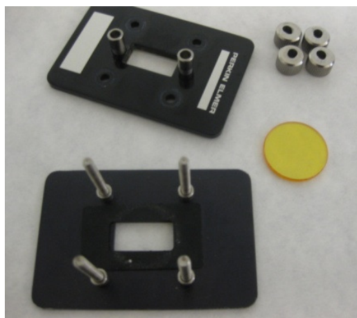
FIGURA 4.7. SOPORTE Y PLACA DE ZNSE UTILIZADA EN LAS MEDICIONES DE ESPECTROSCOPIA FTIR
