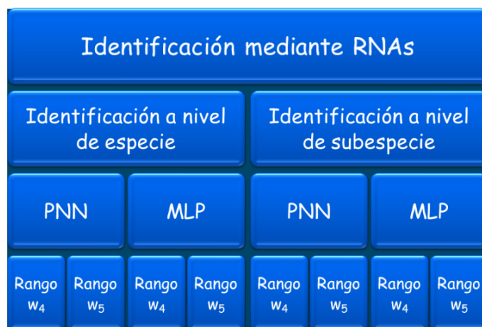
FIGURA 5.4. VARIANTES ENSAYADAS COMO RNAs (8) PARA ENCONTRAR UNA ÓPTIMA SOLUCIÓN DE IDENTIFICACIÓN. RED PERCEPTRON MULTICAPA (MLP) Y RED NEURONAL PROBABILÍSTICA (PNN).
