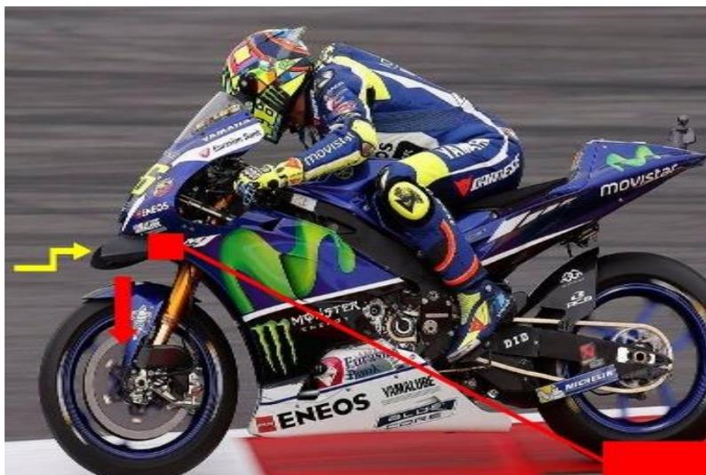
Imagen 3. Colocación de los apéndices aerodinámicos para ejercer más fuerza.
